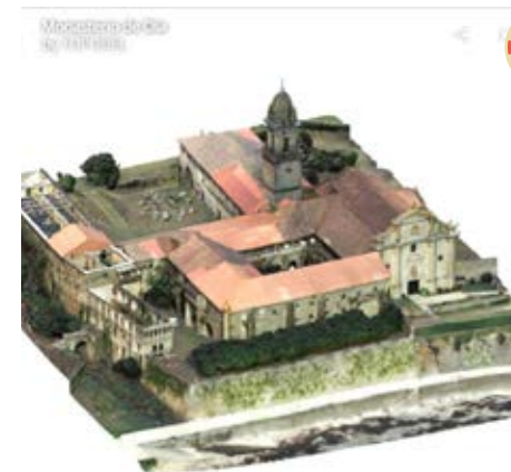
DOS LEVANTAMIENTOS TOPOGRÁFICOS DEL ÁMBITO DE ACTUACIÓN Y TAMBIÉN EL DEL PROPIO EDIFICIO, A TRAVÉS DE TECNOLOGÍAS PUNTERAS COMO LA FOTOGRAMETRÍA Y EL LÁSER -SCAN
